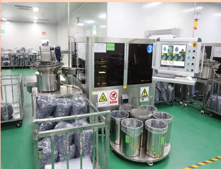
除边工序D级洁净区
