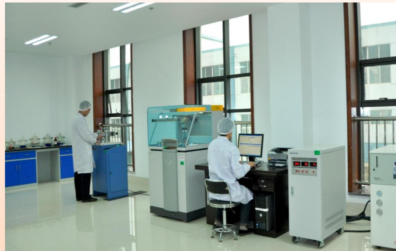
X射线荧光光谱仪 (XRF) 对原料与玻璃成分进行分析
